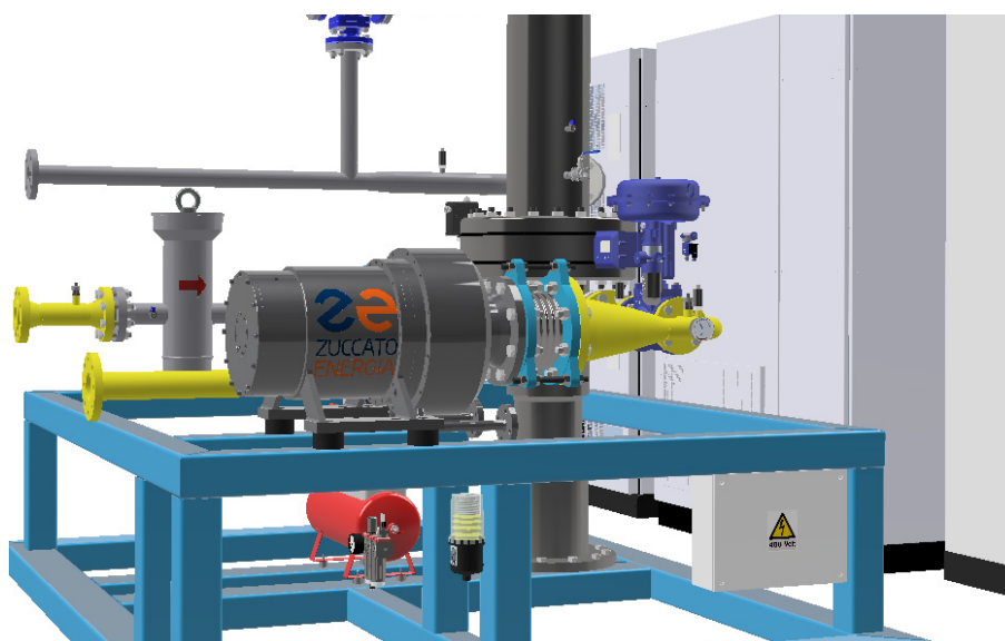
Turbogeneratore alta velocità
