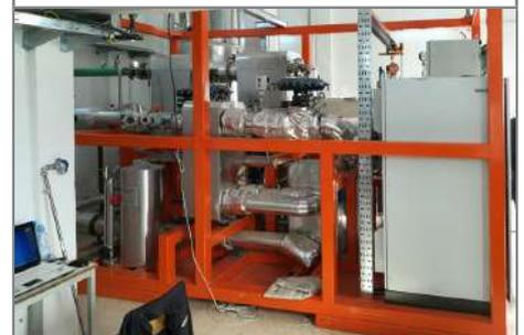
Il modulo ORC ZE-60-DSG, montato sul suo skid, in fase di collaudo
