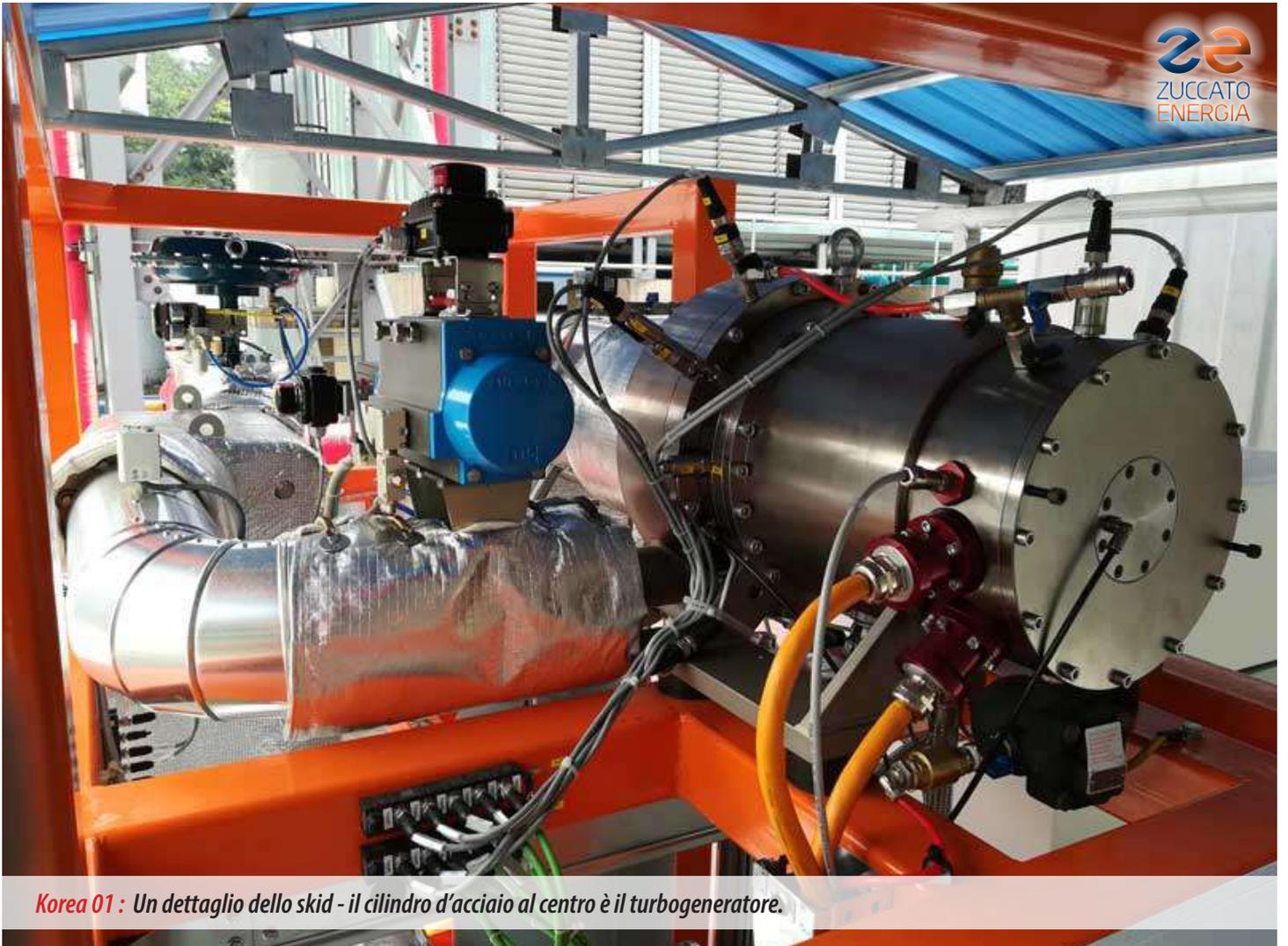
*Korea 01 : Un dettaglio dello skid - il cilindro d'acciaio al centro è il turbogeneratore.*
