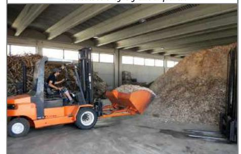
Il cippato viene prelevato per essere introdotto nella tramoggia di carico della caldaia
