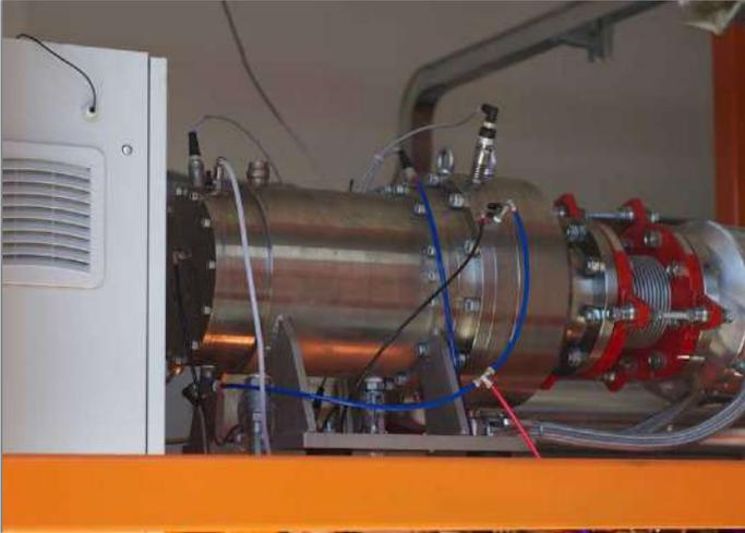
*La turbina da 150 kW<sub>e</sub> del sistema ZE-150-LT*
