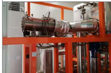
Il turboalternatore nel suo alloggiamento all'interno dello skid
